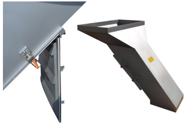
Edelstahlschütte: Maßanfertigung nach Kundenangaben Mit eingebauter easy clean Hochleistungs-Magnetplatte aus seltenen Erden; mit Schnellverschlüssen. Magnetstärke: 4500 Gauß an der Kontaktoberfläche.
